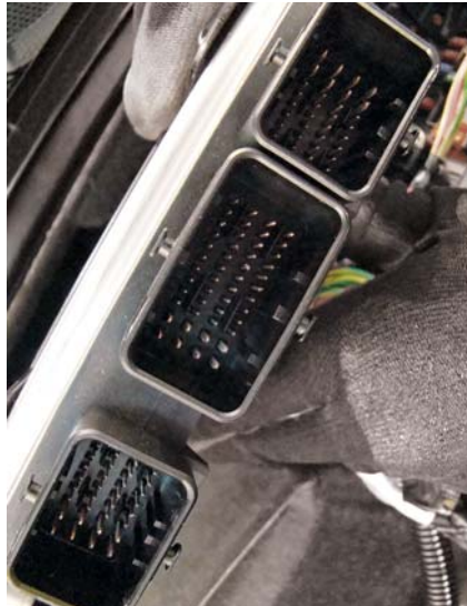
Alojamentos dos conectores na UCE do motor
