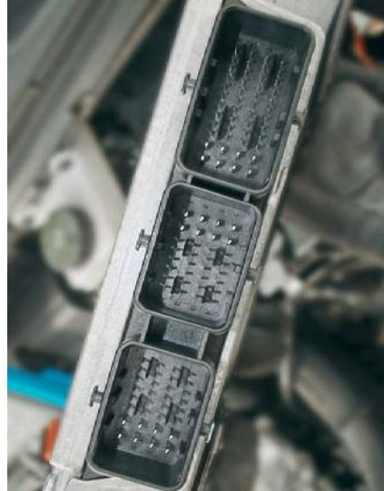
Alojamentos dos conectores na UCE do motor
